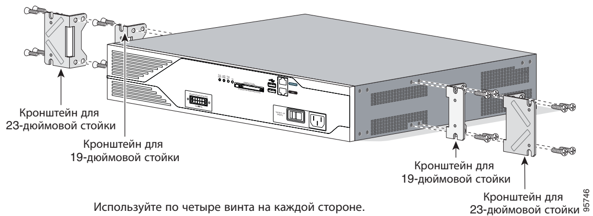
Рис. 9 Крепление скоб для установки по центру передней панелью вперед
