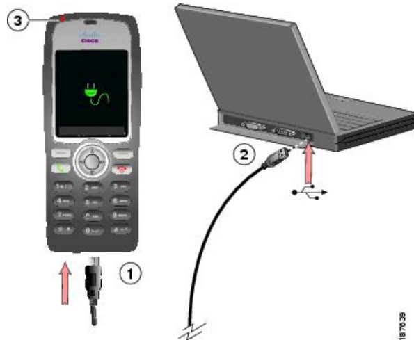
図 8: USB ケーブルと PC を使用した電話機のバッテリーの充電
