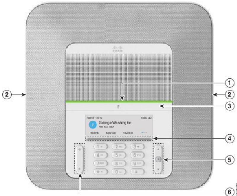
Illustration 11 : Boutons et fonctionnalités du téléphone IP de conférence Cisco 8832
