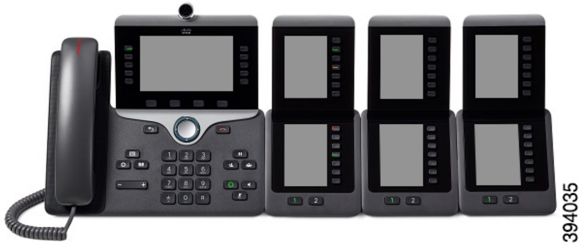
Illustration 27 : Téléphones IP Cisco 8865 avec trois modules d'extension de touches pour téléphone IP Cisco 8865
