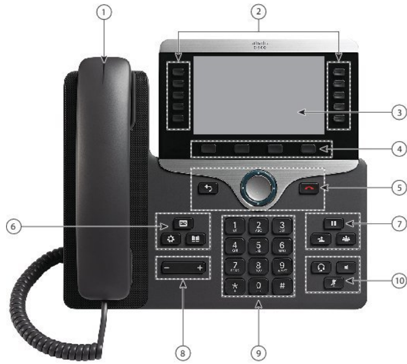
Illustration 7 : Fonctions d'accessibilité pour les personnes aveugles et malvoyantes – La figure montre le téléphone IP Cisco 8861
