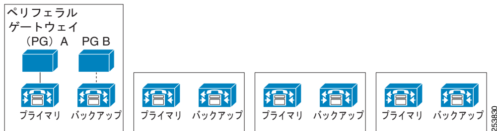
図 26-6 1 つの Agent PG と 4 つの Unified CM サブスクリバ ペアを使用する配置
