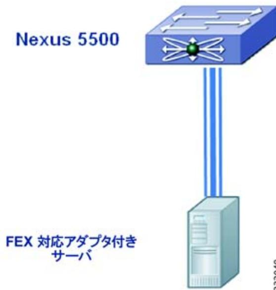
図 1-3 は、親の Cisco Nexus 5500 シリーズ デバイスに接続されている Cisco Nexus 2000 シリーズ ファブリック エクステンダに接続されたサーバ ネットワーク アダプタのトポロジを示しています。
