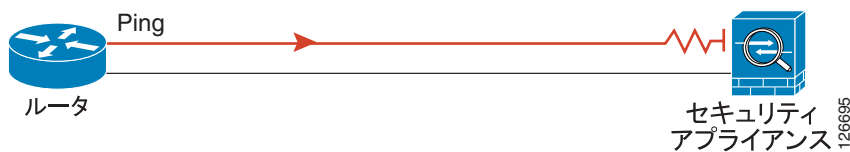
図 36-2 セキュリティ アプライアンス インターフェイスでの ping の失敗
