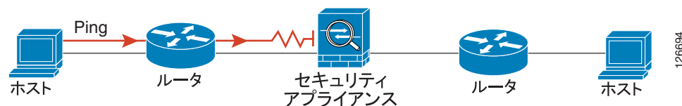
図 36-5 セキュリティ アプライアンスがアドレスを変換しないことによる ping の失敗
