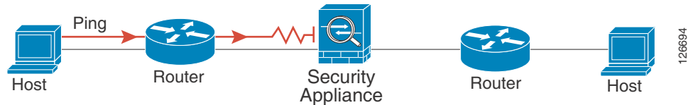
図 14-5 ASA のアドレス変換の問題による ping の失敗
