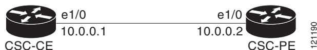
図 6 CSC-PE ルータと CSC-CE ルータ間を直接接続するインターフェイスによるピアリングの設定
