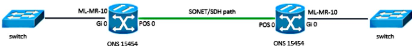
物理连接如拓扑所示。ML-MR-10卡安装在ONS 15454节点上,ML-MR-10接口Gi0与交换机上的接口连接,两端相同。
