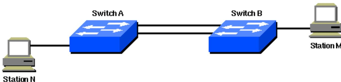
Nesta rede, um link redundante é planejado entre o Switch A e o switch B. Contudo, esta instalação cria a possibilidade de um Loop de Bridging. Por exemplo, uma transmissão ou um pacote de transmissão múltipla que transmite da estação M e sejam destinado para a estação N
