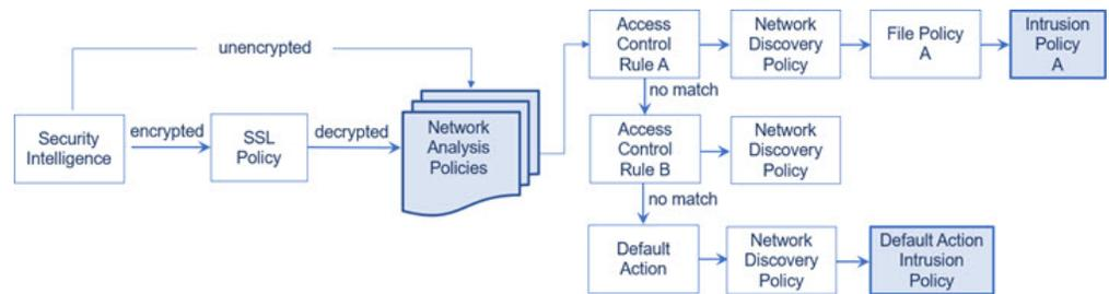
インライン展開（つまり、ルーテッド、スイッチド、トランスペアレントインターフェイスまたはインラインインターフェイスのペアを使用して関連設定がデバイスに展開される展開）では、システムは上図のプロセスのほぼすべての段階において、追加のインスペクションなしでトラフィックをブロックすることができます。セキュリティインテリジェンス、SSLポリシー、ネットワーク分析ポリシー、ファイルポリシー、および侵入ポリシーのすべてで、トラフィックをドロップまたは変更できます。唯一の例外として、パッシブにパケットを検査するネットワーク検出ポリシーは、トラフィックフローに影響を与えることができません。
