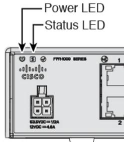
**ステップ 3** デバイスの背面または上部にあるステータス LED を確認します。緑色に点灯している場合は、電源投入時診断に合格しています。
