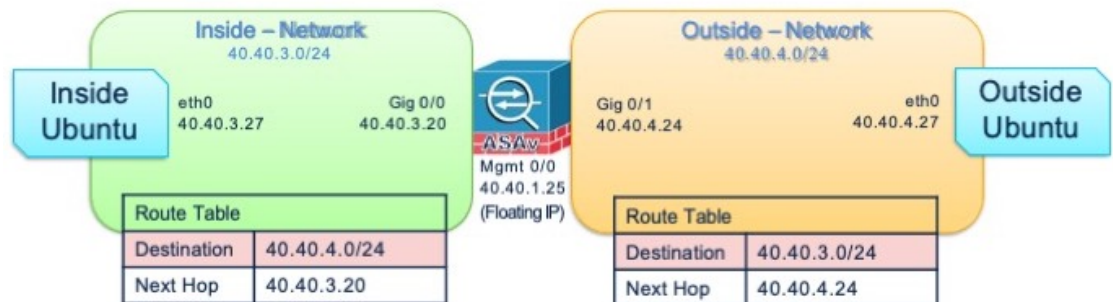
図 2: OpenStack への ASA の導入例
