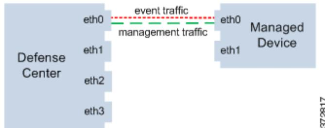
複数の管理インターフェイスを使用する場合、トラフィックチャネルを2つの管理インターフェイスに分割することによりパフォーマンスを向上できます。それによって両方のインターフェイス容量が増し、トラフィックフローが増加します。一方のインターフェイスで管理トラフィックチャネルを伝送し、もう一方のインターフェイスでイベントトラフィックチャネルを伝送します。いずれかのインターフェイスで障害が発生した場合は、すべてのトラフィックがアクティブインターフェイスに再ルーティングされるため、接続が維持されます。
