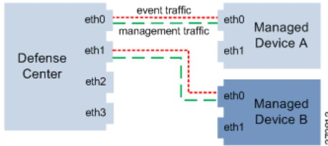
防衛センターに 8000 シリーズ の管理対象デバイスを登録するときは、接続の両側で自動ネゴシエーションするか、または両側を同じ固定速度に設定して安定したネットワーク リンクを確保する必要があります。8000 シリーズ 管理対象デバイスは、半二重ネットワーク リンクをサポートしません。また、接続の反対側と異なる速度またはデュプレックス コンフィギュレーションもサポートしません。
