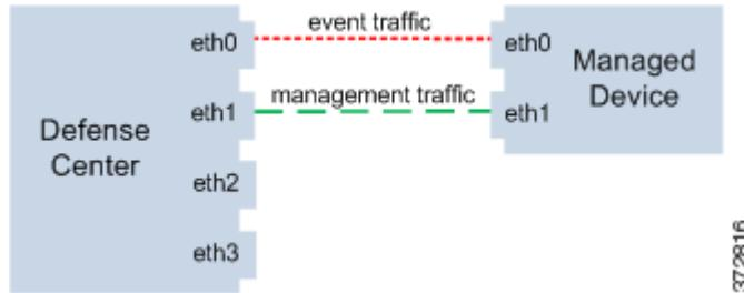
専用の管理インターフェイスを使用して、複数のデバイスからのイベントトラフィックのみを伝送することができます。この設定では、管理トラフィックチャネルを伝送する別の管理インターフェイスに各デバイスを登録し、すべてのデバイスからのすべてのイベントトラフィックを、防御センター上の1つの管理インターフェイスで伝送します。インターフェイスで障害が発生した場合は、トラフィックがアクティブインターフェイスに再ルーティングされるため、接続が維持されます。すべてのデバイスのイベントトラフィックが同じインターフェイスで伝送されることから、トラフィックはネットワーク間で分離されることに注意してください。
