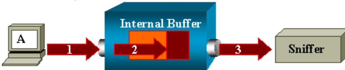
スイッチが破損したパケットを受信した場合、入力ポートは通常そのパケットを廃棄します。したがって、パケットは出力ポートには表示されません。トラフィックをキャプチャするという点に関しては、スイッチは完全に透過的ではありません。このセクションのシナリオで、同様にスニファに破損したパケットが表示された場合は、出力セグメントに、ステップ3でエラーが生成されています。
