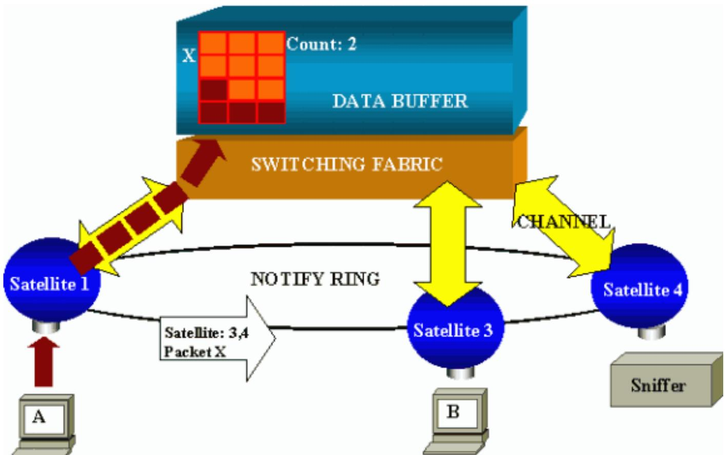
スイッチのポートは、ラジアルチャネル経由でスイッチングファブリックと通信する衛星局に接続されます。上部構造として、すべての衛星局はシグナリングトラフィック専用の高速通知リング経由で相互に接続されます。
