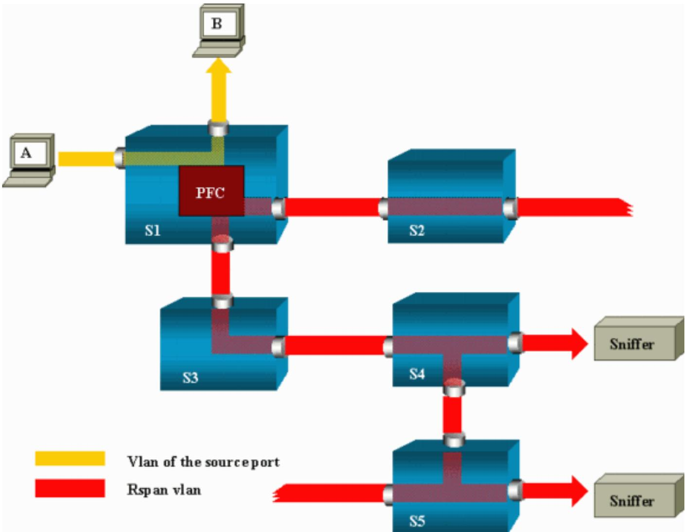
この例では、ホスト A から送信されるトラフィックをモニタするために RSPAN を設定します。ホスト A がホスト B に宛てたフレームを生成すると、パケットは Catalyst 6500/6000 Policy Feature Card ( PFC; ポリシー フィーチャ カード ) の Application-Specific Integrated Circuit ( ASIC; 特定用途向け集積回路 ) により、事前定義した RSPAN VLAN にコピーされます。そこから、パケットは RSPAN VLAN に属する他のすべてのポートにフラッディングされます。ここで表されるスイッチ間のリンクは、すべてトランクで、これは、RSPAN の要件です。唯一のアクセスポートは宛先ポートで、ここにスニファが接続されます (ここでは、S4 および S5)。
