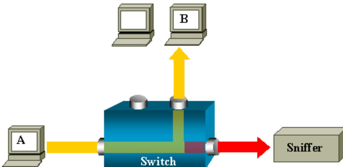
この図では、ホスト A により送信されるすべてのパケットのコピーを受信するように設定されたポートに、スニファが接続されます。このポートを SPAN ポートと呼びます。このドキュメントの他のセクションでは、機能の範囲を単にポートのモニタに留まらせないようにするために、この機能を厳密に調整する方法について説明しています。
