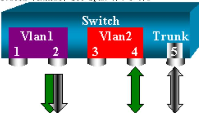
この場合、SPAN ポートで受信するトラフィックには、必要なトラフィックとトランク 6/5 で搬送されるすべての VLAN が混在しています。たとえば、パケットが VLAN 2 のポート 6/4 が VLAN 1 のポート 6/5 から来るかどうか、宛先ポートで区別する方法はありません。ほかの目的で VLAN 2 の SPAN を使用します。
