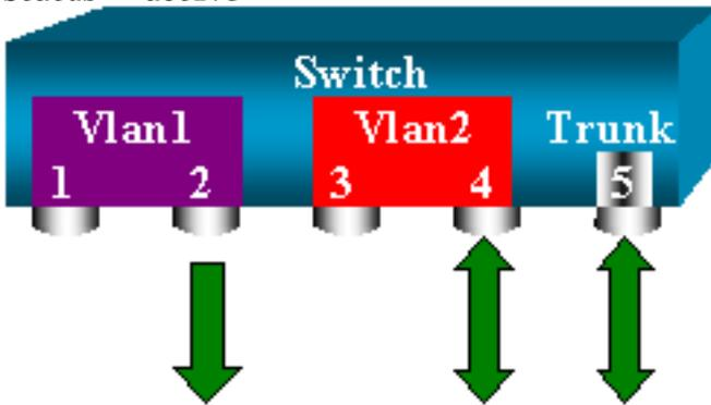
このコマンドでは、モニタ対象のすべてのトランクから VLAN 2 だけを選択するため、目的が達成できます。この filter オプションで複数の VLAN を指定できます。
