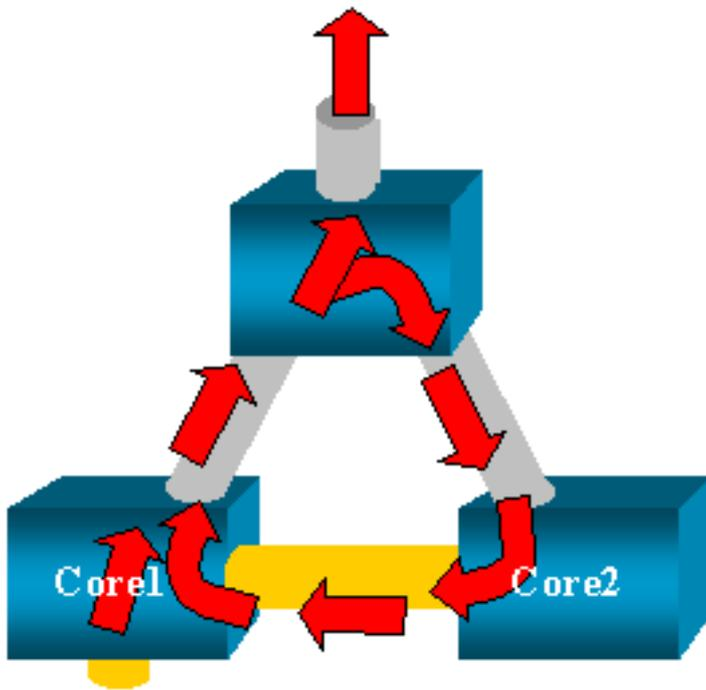
注: CatOS での `inpkts` (入力パケット) オプションの導入により、SPAN 宛先ポートではデフォルトですべての着信パケットが廃棄され、この障害のシナリオを防止しています。しかし、Catalyst 2900XL/3500XL シリーズ スイッチでは、この潜在的な問題がまだ残っています。
