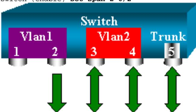
この設定では、最低限、VLAN 2 に属するトラフィックだけをトランクからモニタします。問題は、望んでいないポート 6/3 からのトラフィックも受信してしまうことです。CatOS には、トランクからモニタする VLAN を選択することを可能にする、次のようなキーワードが備わっています。
