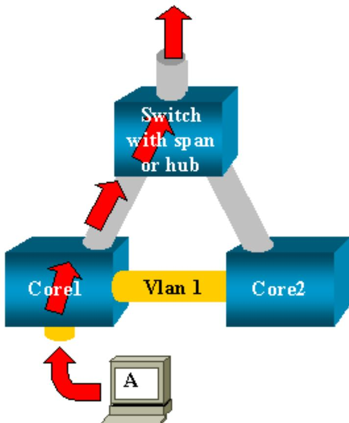
2つのコアスイッチが、トランクによってリンクされています。この場合、各スイッチには、複数のサーバ、クライアント、または他のブリッジが接続されています。管理者が、SPAN を設定した複数のブリッジで現れる VLAN 1 をモニタするとします。管理者は、各コアスイッチで VLAN 1 全体をモニタする SPAN セッションを作成します。そして、これら2つのセッションをマージするため、宛先ポートを同じハブ（または、他の SPAN セッションを使用する同じスイッチ）に接続しています。
