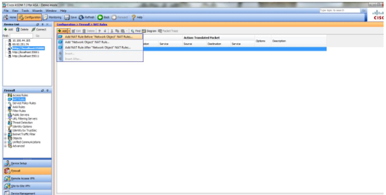
2. 手動のための設定を記入して下さい/二度変換をネットワークアドレス交換して下さい。ソースインターフェイス ドロップダウン リストで、**中**を選択して下さい。デスティネーションインターフェイス ドロップダウン リストで、**dmz** を選択して下さい。送信元アドレスフィールドでは、内部ネットワーク オブジェクト ( obj-192.168.100.0 ) を入力して下さい。宛先アドレスフィールドでは、変換された DMZ サーバ IP オブジェクトを入力して下さい ( 172.20.1.10 )。出典 NAT 型ドロップダウン リストで、**ダイナミック PAT (非表示)** を選択して下さい。送信元アドレス[処理: 変換されたパケット セクション]フィールドは、**dmz** を入力します。宛先アドレス[処理: 変換されたパケット セクション]フィールドは、DMZ サーバ実質 IP オブジェクト ( obj-10.10.10.10 ) を入力します。
