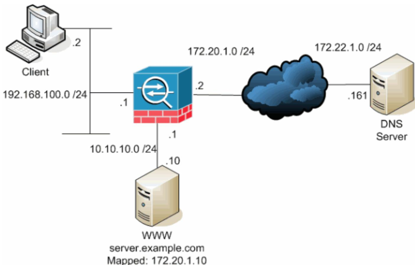
この図は、この状況の例です。この場合、192.168.100.2 のクライアントは 10.10.10.10 で WWW サーバにアクセスするために `server.example.com` URL を使用したいとします。クライアントの DNS サービスは、172.22.1.161 の外部 DNS サーバによって提供されます。この DNS サーバは他のパブリック ネットワーク上に存在するため、WWW サーバのプライベート IP アドレスを認識していません。ただし、WWW サーバのマップ アドレス ( 172.20.1.10 ) は認識しています。そのため、この DNS サーバには `server.example.com` を 172.20.1.10 に変換する IP ア
