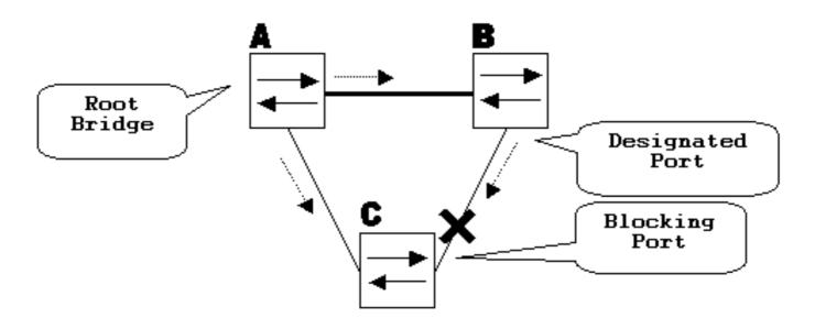
通常の動作中、ブリッジBはリンクB-Cの指定ポートです。ブリッジBはBPDUをCに送信しますが、Cはブロッキングポートです。B からの BPDU がそのリンク上に正しく送信されていることが C で認識されている間は、ポートがブロックされます。
