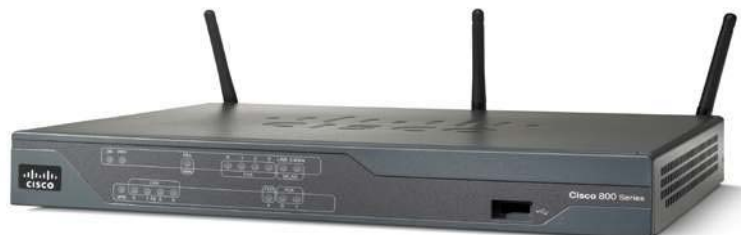
그림 1. 통합 802.11n 액세스 포인트를 포함한 Cisco 861 통합 서비스 라우터
