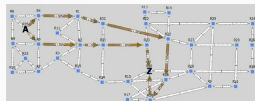
図4: Cisco MATE Liveに表示されたLSPの分離結果
