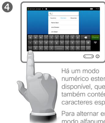
4 Há um modo numérico estendido disponível, que também contém caracteres especiais. Para alternar entre o modo alfanumérico e o modo numérico estendido, toque na tecla no canto inferior esquerdo do teclado.
