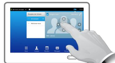
Ajuste **Panorâmica**, **Inclinação** e **Zoom**, conforme necessário.
