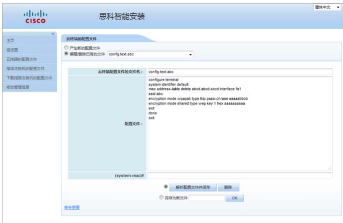
图 2-14 Cisco Edge 的配置文件屏幕 — 修改文件
