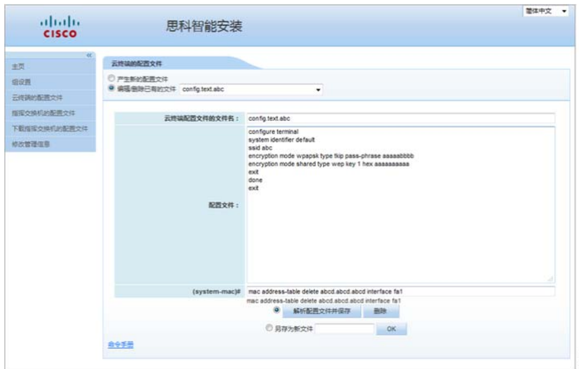
图 2-13 Cisco Edge 的配置文件屏幕 — 修改文件
