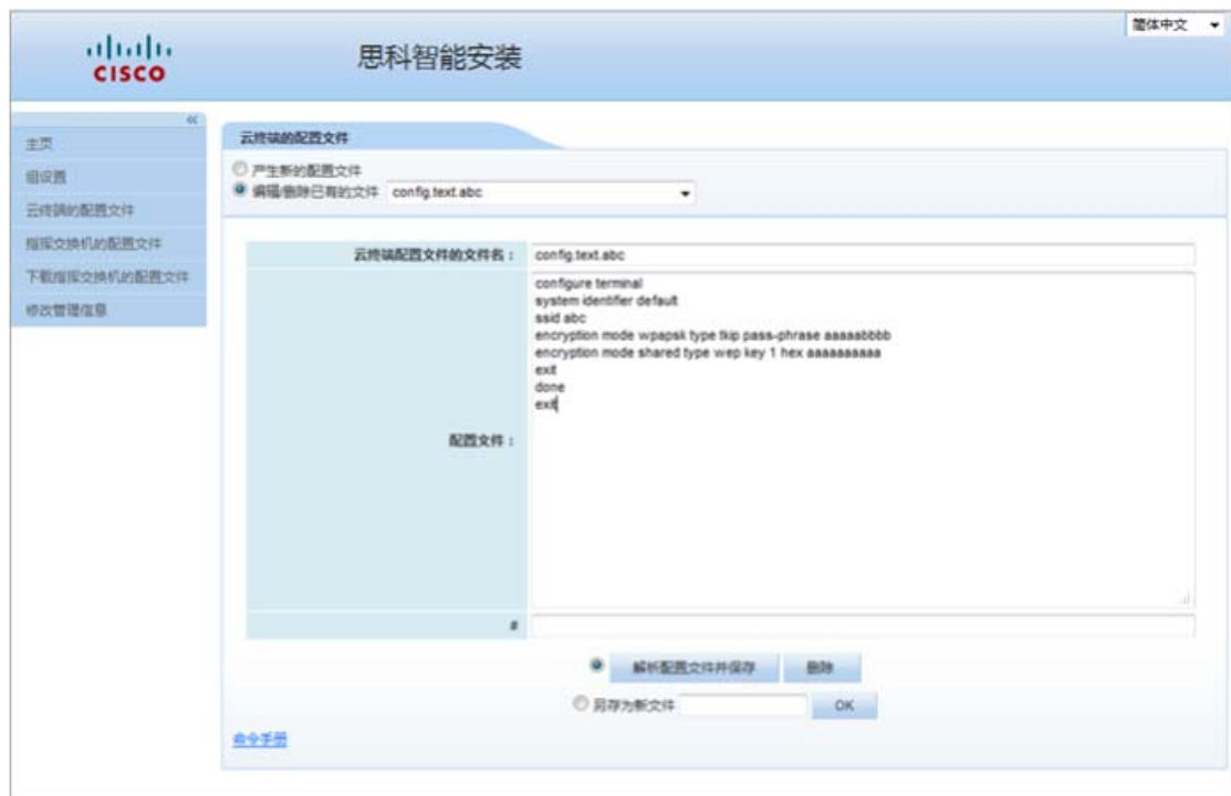
图 2-12 Cisco Edge 的配置文件屏幕 — 修改文件
