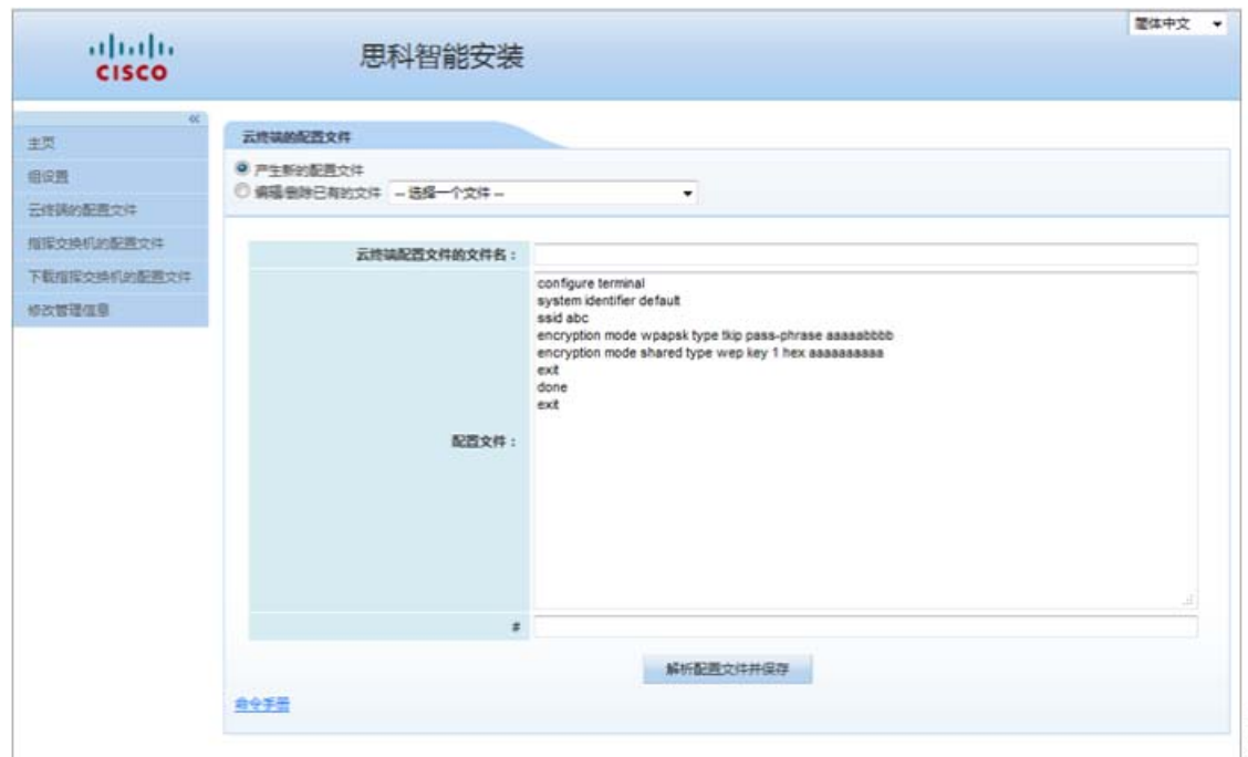
图 2-11 Cisco Edge 的配置文件屏幕 — 产生新文件
