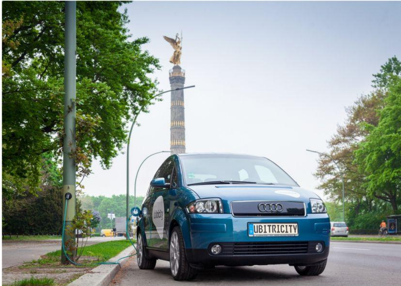
Zukunftsvision einer Ladesäule als Straßenlaterne ©ubitricity Gesellschaft für verteilte Energiesysteme mbH
