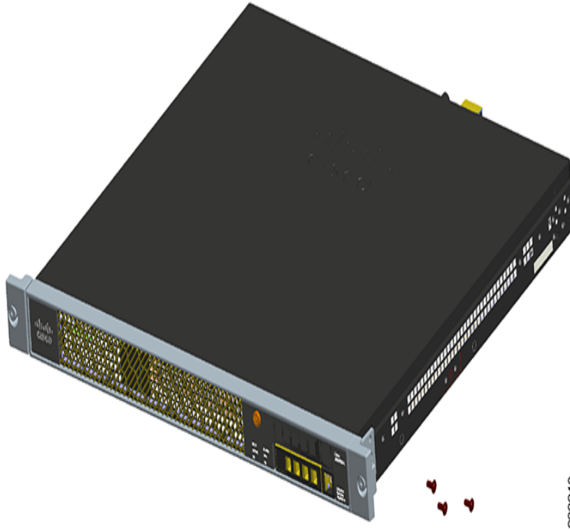
그림 3-6 나사 3개로 다이캐스트 브래킷 설치
