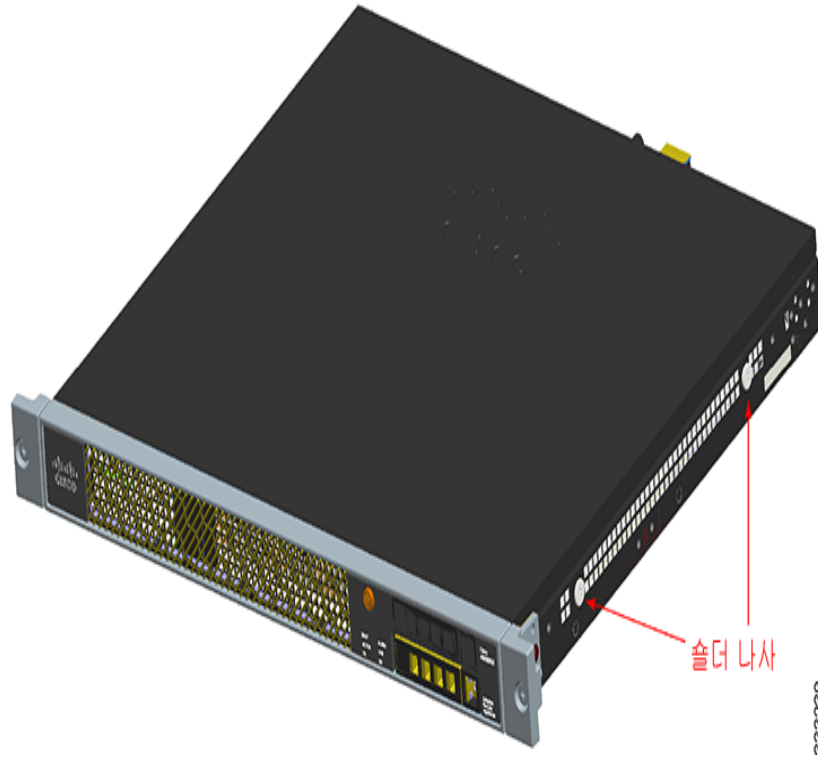
그림 3-7 새시의 양쪽에 슬더 나사 2개 설치
