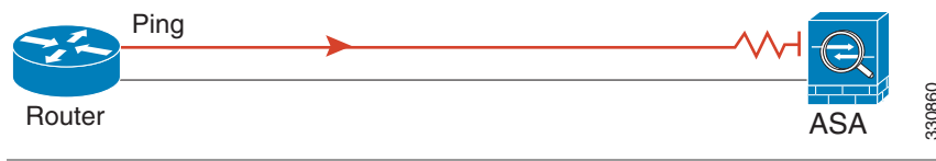
图 14-4 ASA 没有返回路由引发的 ping 故障
