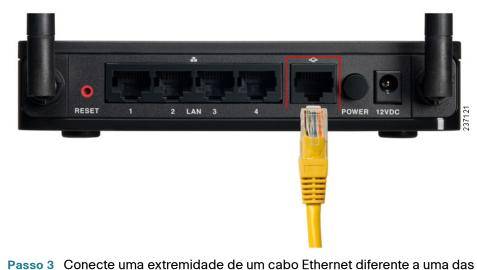
portas LAN (Ethernet) disponíveis na parte traseira da unidade. (Neste exemplo, a porta LAN 1 é usada.) Conecte a outra extremidade a uma porta Ethernet no computador que será usado para executar o Assistente de configuração e o Gerenciador de dispositivos via Web.
